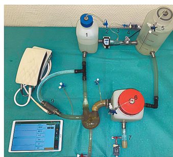
Рисунок 3. Макет центробежного насоса с отдельным имплантируемым контроллером
