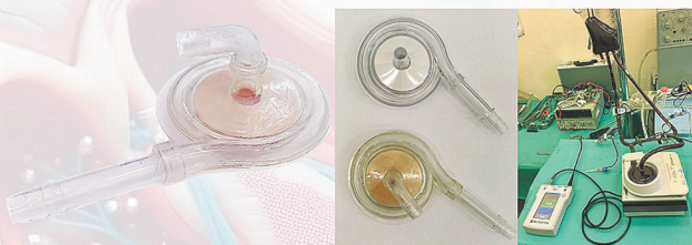
Рисунок 4. Макет центробежного насоса в сравнении с аналогом Rotaflow (Maquet) и стендовые исследования гемолиза
