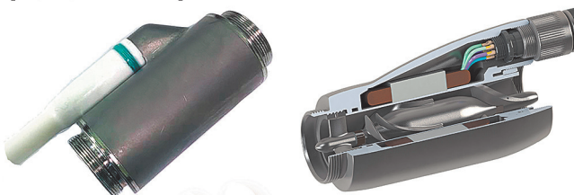
Рисунок 1. Экспериментальная модель и 3D модель осевого насоса для терапии сердечной недостаточности у детей
