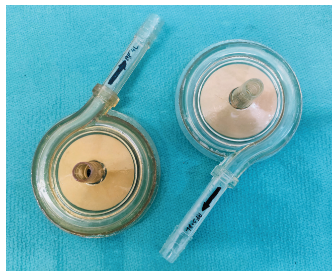
Рис. 3. Экспериментальные модели насосов из фотополимера с оригинальным и модифицированным ротором
