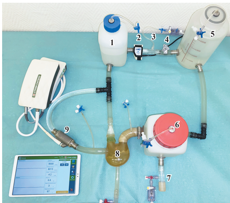
Рис. 3. Принципиальная схема гидродинамического стенда: 1 – артериальная емкость; 2 – датчик аортального потока; 3 – датчик измерения артериального давления; 4 – системное гидравлическое сопротивление; 5 – венозный резервуар; 6 – резервуар, имитирующий систему «легочные вены – левое предсердие»; 7 – датчик измерения давления в предсердии; 8 – ИЖС, имитирующий левый желудочек сердца при ОЛЖ; 9 – испытуемый насос
