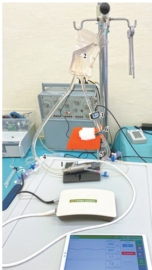
Рис. 2. Схема гидродинамического стенда: 1 – осевой насос; 2 – резервуар; 3 – датчик потока жидкости; 4, 5 – датчики давления на входе и выходе из насоса; 6 – гидравлическое сопротивление
