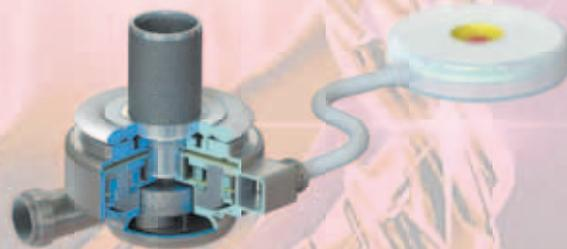
Рисунок 3. Макет центробежного насоса с отдельным имплантируемым контроллером
