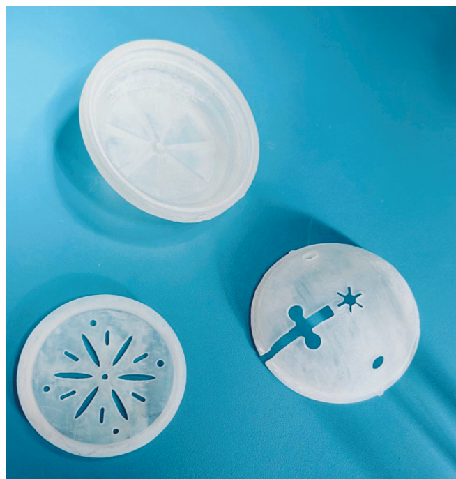
Рис. 4. Изготовленные детали контейнера для донорских легких мелких животных
