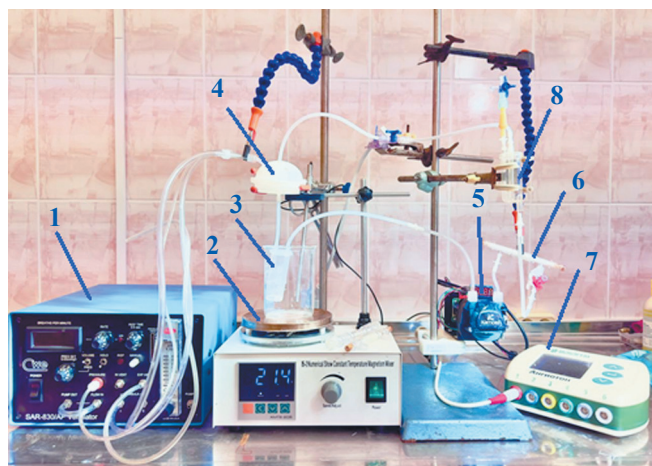
Рис. 2. Разработанный стенд для нормотермической машинной перфузии донорских легких у мелких животных. 1 – аппарат для вентиляции легких; 2 – нагревательное устройство; 3 – герметичная емкость; 4 – разработанный контейнер для донорских легких; 5 – роликовый перистальтический насос; 6 – разработанный малообъемный мембранный оксигенатор; 7 – аппарат для измерения давления; 8 – пузырьковый фильтр
