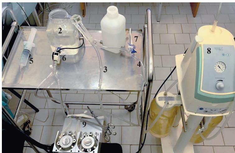
Рис. 7. Гидродинамический стенд: 1 – канюля; 2 – кардиотомический резервуар; 3 – воздушный канал; 4 – жидкостный канал; 5 – устройство подачи воздуха; 6 – датчик измерения потока / подсчета МП; 7 – датчик измерения вакуума; 8 – система вакуумного отсоса; 9 – роликовый насос
