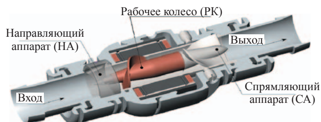
Рис. 9. Трехмерная модель конструкции детского насоса
