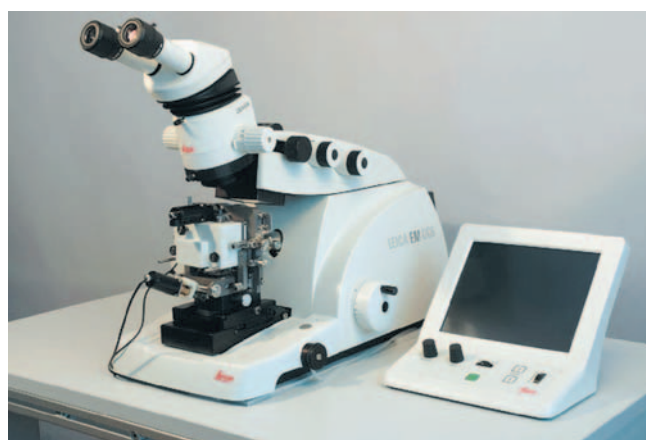
Рис. 1. Экспериментальная установка для сканирующей зондовой нанотомографии Ntega Tomo, комбинирующая ультрамикротом и сканирующий зондовый микроскоп
