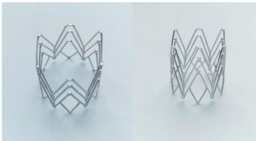
Рис. 2. Текущая версия опорного каркаса протеза, изготовленная из сплава кобальт-хрома методом лазерной резки с приданием конечной геометрии
