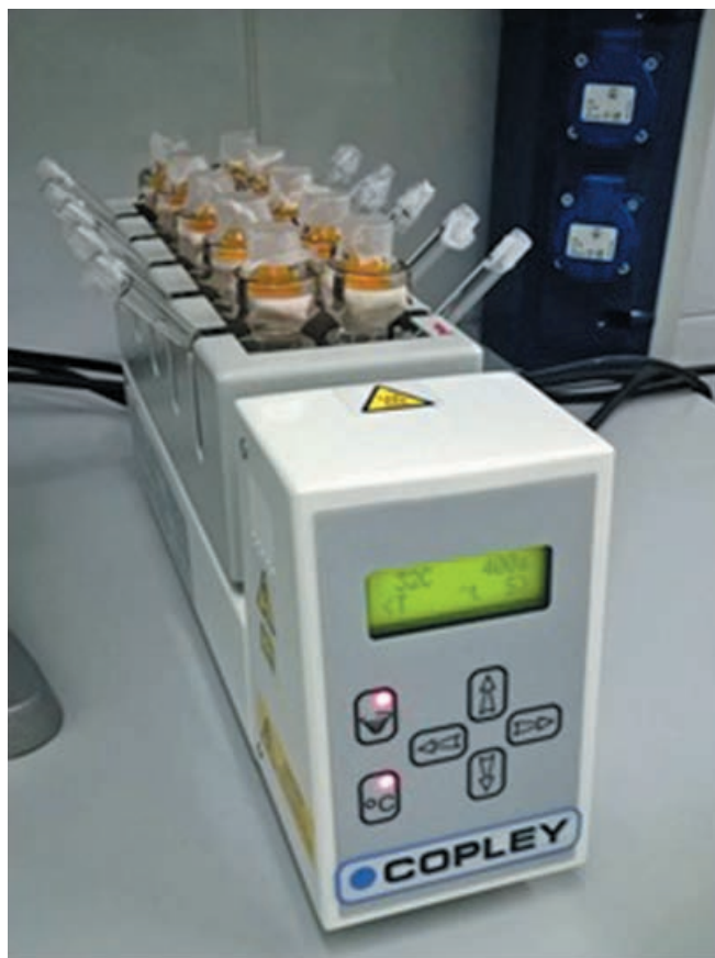
Рис. 3. Анализатор диффузии лекарственных препаратов HDT 1000 (Copley Scientific Ltd., Великобритания)
