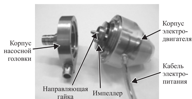
Рис. 3. Канальный центробежный насос. Макетный образец из титана
