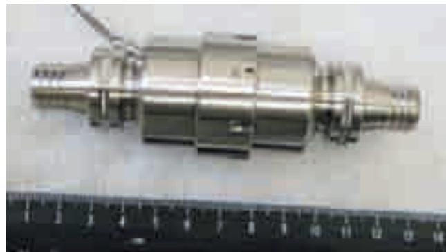
Рис. 6. Имплантируемый осевой ВИШ-насос. Макетный образец из титана
