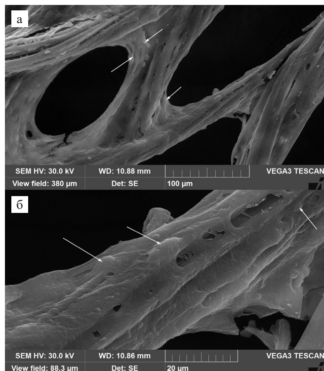
Рис. 1. СЭМ-изображения поверхности нитей тканевого скаффолда «Фиброплен-Газ 80» с культивированными фибробластами мыши 3Т3 (срок культивирования 7 суток): а – \times 1000 ; б – \times 4310 . Стрелками указаны примеры фибробластов
