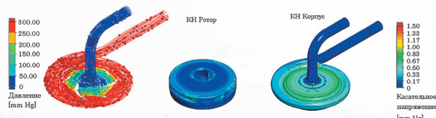
Рисунок 3. Моделирование течения жидкости и КН в разработанной модели насоса
