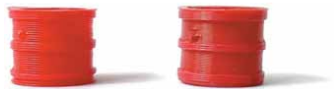
Рис. 7. Слева – стент до создания промежуточного слоя из полидопамина; справа – стент с промежуточным слоем из полидопамина
